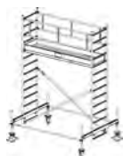
Munkamagasság: 4,40 m Állványmagasság: 3,40 m Állómagasság: 2,40 m
