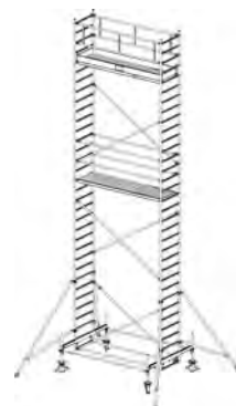
Munkamagasság: 9,40 m Állványmagasság: 8,40 m Állómagasság: 7,40 m
