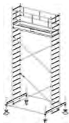
Munkamagasság: 6,40 m Állványmagasság: 5,40 m Állómagasság: 4,40 m
