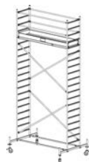
Munkamagasság: 6,40 m Állványmagasság: 5,40 m Állómagasság: 4,40 m
