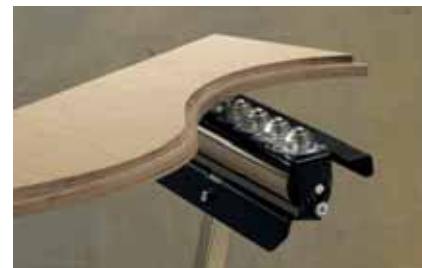
a golyósgörgős alátámasztás lehetővé teszi a munkadarab többirányú elmozdulását, így pl. az íves marásnál a munkadarab nekivezetését
