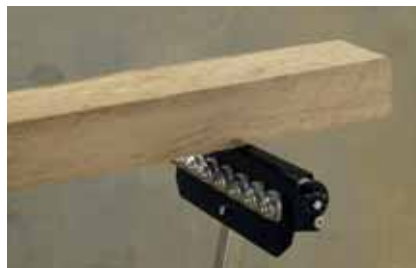
a biztos támaszték a munkaasztal felfekvőfelületének meghosszabbításához és a hosszú munkadarabok megtámasztásához használható
