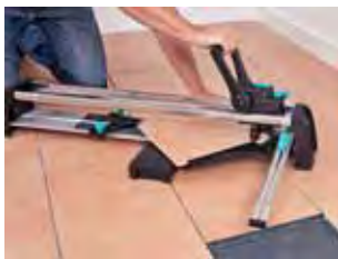
speciális vezetés a diagonális vágáshoz
