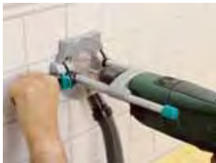
kiegészítő fogantyú a pontos illesztéshez és a fúrás közbeni elcsúszás megakadályozására
