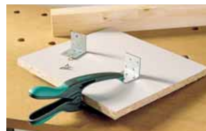
a nagy megfogási mélység biztosítja a munkadarab életől távoli rögzítést
