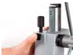
a furatmélységet a gyorsállítási mélységállító állítja
