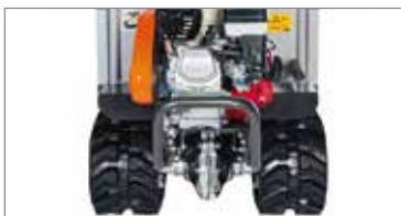
Hátsó fém védőburkolat a gépkezelő biztonsága érdekében.
