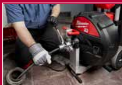
A CABLE DRIVE mechanizmus automatikusan adagolja és visszahúzza a kábelt
