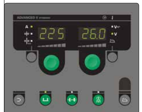
Advanced panel például olyan szolgáltatásokkal, mint a PowerArc™ és a DUO Plus™. A DUO Plus funkció AVI-szerű hegesztési eredményt és a varratfürdő jobb szabályozását teszi lehetővé. Az Advanced panel szinergikus programokat tartalmaz MIG-forrasztáshoz, illetve lágyacél, rozsdamentes acél és alumínium tömör és porbeles huzallal történő hegesztéséhez is.
