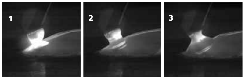
IAC™ – gyökvarratok függőlegesen lefelé hegesztése egy távfűtőcsőben. A hegesztési sebesség lényegesen nagyobb, mint a hagyományos, felfelé hegesztés esetén.
