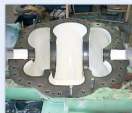
A korrodált és kopott tengely felújítása Loctite® 3478 Superior Metal alkalmazásával. Kikeményedés után méretre munkálással fejeződött be a tengely felújítása. Ezután az összes alkatrész bevonásra került Loctite® Nordbak® 7228 fehér színű ecsetelhető kerámiával (ivóvíz rendszerekben alkalmazhatósági bizonylattal rendelkezik).
