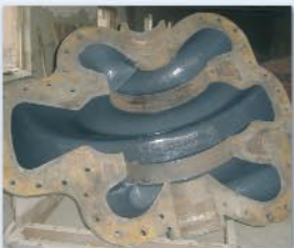
A szivattyúház felújítás után.
