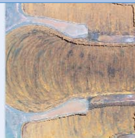
A fedél és a bronz járókerék a felújítás előtt. Az első lépés SA-3 minőségű szemcseoszórás a 75 µm-es felületi profil biztosítása érdekében.
