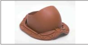
LTVMP cserepeslemezhez LPA, LPA Nova, LPA Classic magas cserepeslemezhez Méret: 260 x 330 mm Tetőhajlás: 14-45° (csőtől függően)
