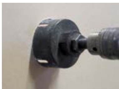
1) A furatok kialakítása a gipsztáblába 73,5 mm átmérővel a VDS 68 típusú fúróval (lásd old. 1-79).
