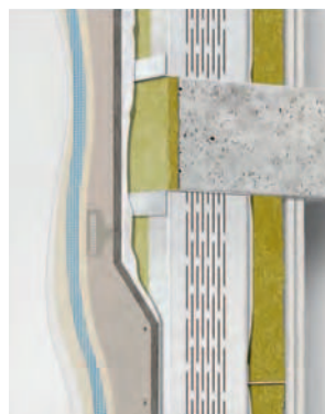
Födémre állított szerkezet perforált profilú vázzal
