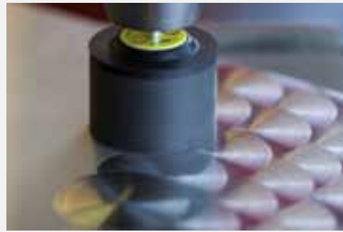
Az SFM 656 R-Flex márványtesttel való dekoratív csiszolás példája nemesacéllemezen
