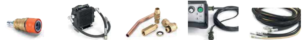
11 Gardena-Tema vízadapter 12 Külső hűtő olyan esetekre, amikor plusz hűtésre van szükség 13 Kiegészítő hűtőszerelevény olyan esetekre, amikor a belépő víz hőmérséklete 25°C-nál magasabb, vagy ha a gépből kilépő víz sebessége 5 l/percnél alacsonyabb 14 CAN kábel a PP 455 E modellhez 15 Tömölécsetlet összekötő elemekkel együtt a PP 455 E modellhez
