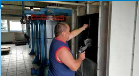
Az öntöttvas alkatrészek elektrosztatikus porfestése
