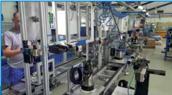
Merülőszivattyúk összeszerelése a szerelősoron
