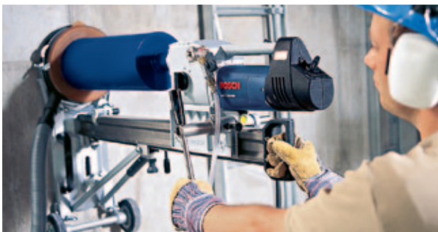
Nedves fúrás rendszerrel: Bosch GDB 2500 WE gyémánt fúrógép, gyémánt fúrókoronák, S 500 A fúróállvány, elszívóberendezés és univerzális porszívó.
