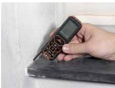
Kitámasztó tűske a sarokban történő pontos méréshez
