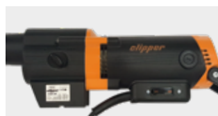
Alumínium test, javított hőelosztás
