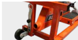
Porszívó csatlakozó Ø40mm
