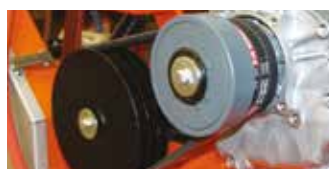
Centrifugális tengelykapcsoló (csak JUMBO P13)
